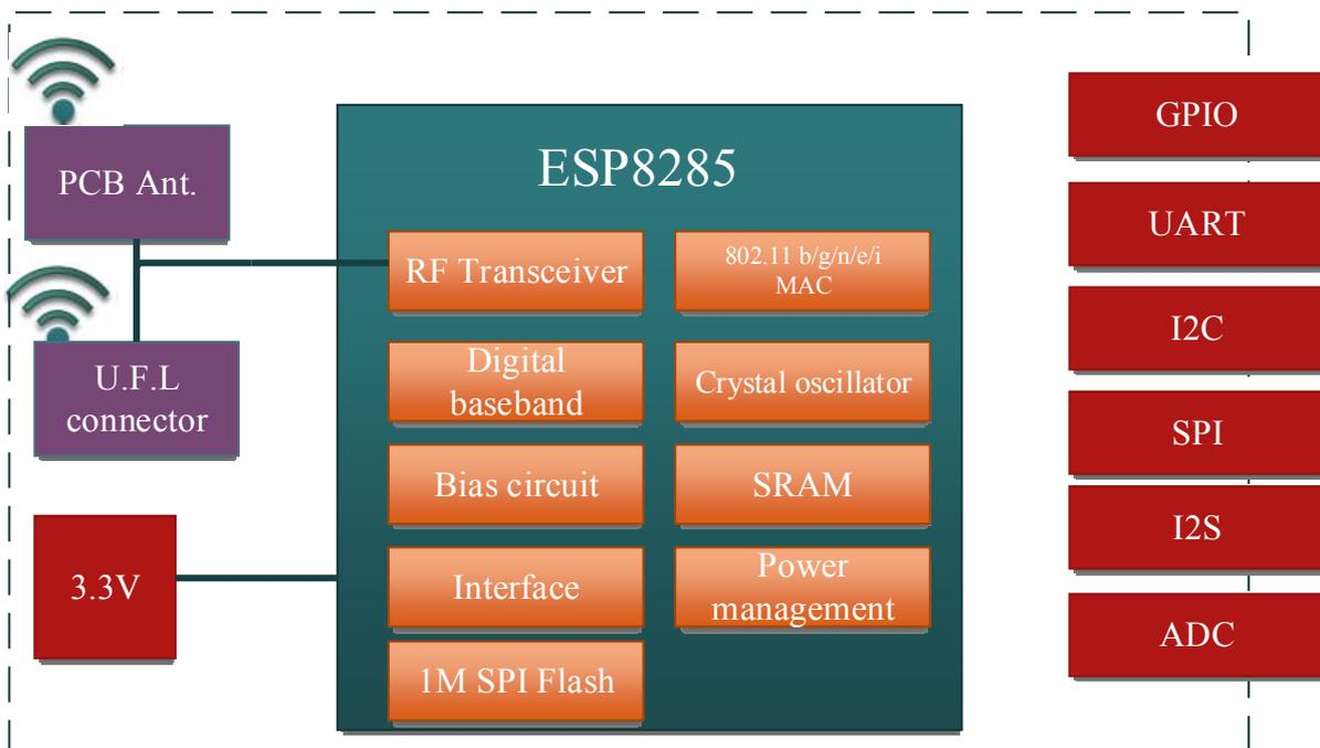
Fig. 1.1 Module Structure
