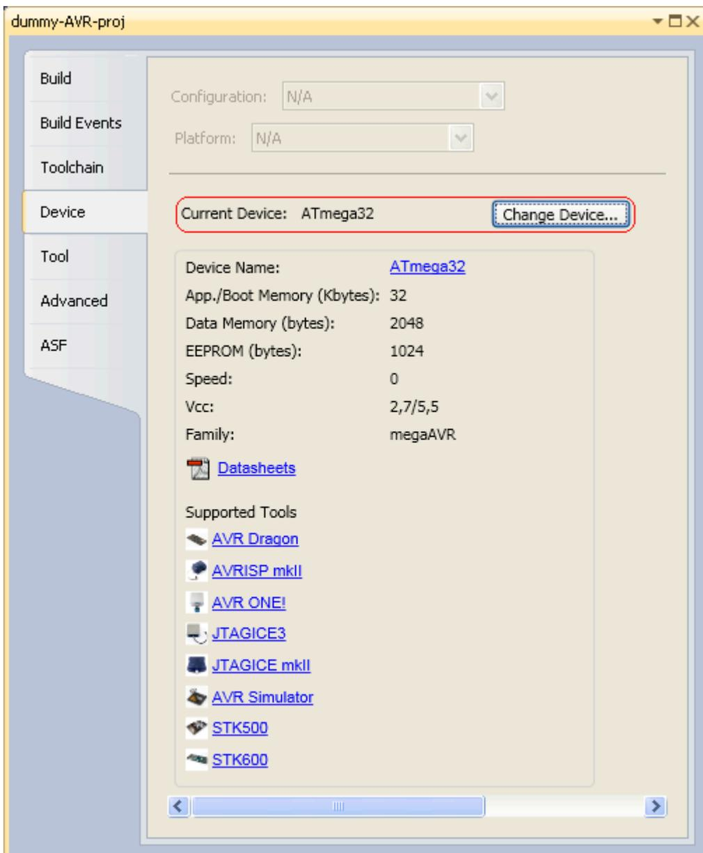
После того, как подключен файл `io.h` и задан тип микроконтроллера для проекта, можно в коде программы на языке C использовать имена регистров AVR. Через имена регистров осуществляется доступ к портам GPIO микроконтроллера.
